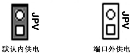
图 2-4 输出供电选择跳线（出厂默认为断开）
