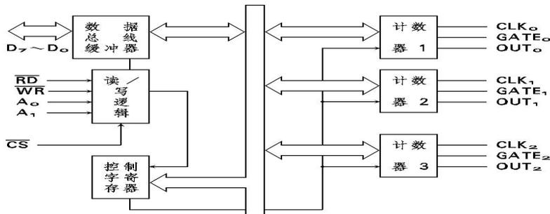
图 3 8253 内部结构图
