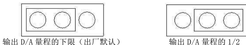
图 5 D/A 上电输出电压选择
